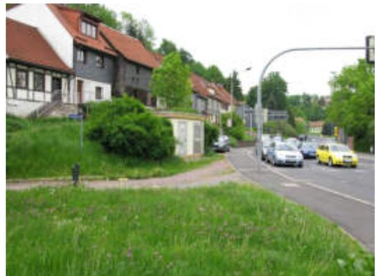
Im Bereich der Gothaer Straße wird die anliegende Wohnbebauung durch häufige Ampelrückstaus an der Kreuzung ehem. Intertank belastet. Im gesamten unteren Bereich bis Anbindung Schmiedefelder Straße sind erhebliche Fahrbahnschäden anzutreffen. Besonders Lkw und Busse erzeugen laute Stoßgeräusche. Oberflächenerneuerung ist dringend erforderlich.
